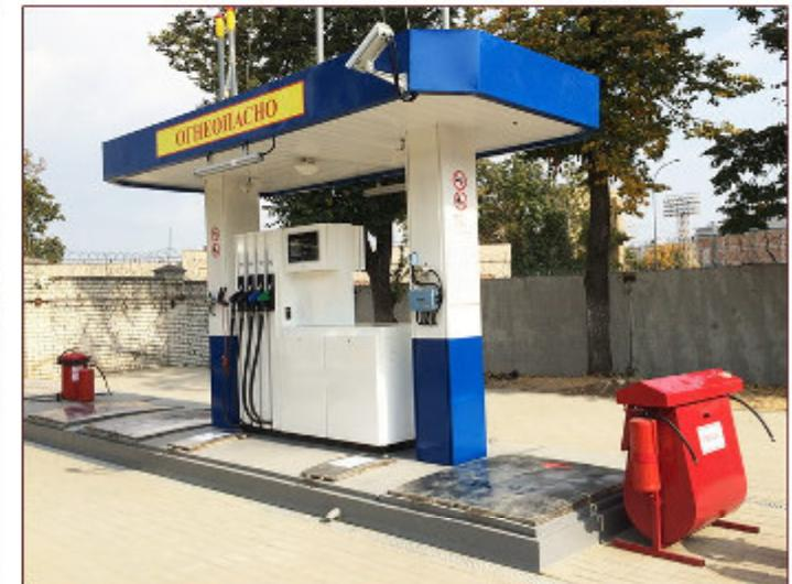
Назначение БААЗС - прием, хранение и отпуск топлива (светлых нефтепродуктов) в баки автомобильной и специальной техники; ведение учета количества выданного топлива.
